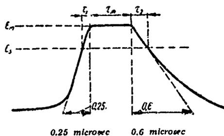
Fig. 46. Square pulse parameters
